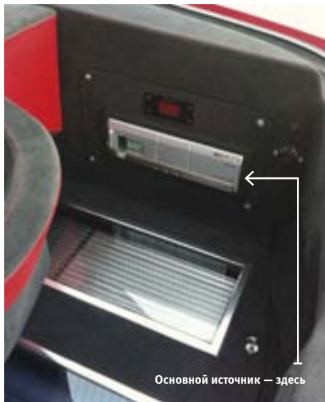
Головное устройство, по существу — центр управления, а не источник
