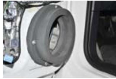
Двери попали в серьёзный оборот, здесь и уменьшение литража, и увеличение жёсткости, и формирование отдельного объёма для СЧ
