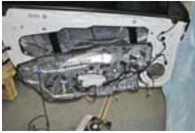
Двери попали в серьёзный оборот, здесь и уменьшение литража, и увеличение жёсткости, и формирование отдельного объёма для СЧ
