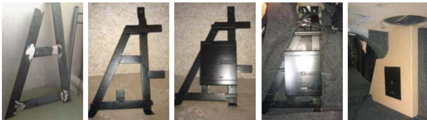
Изготовление и монтаж рамы процессора
