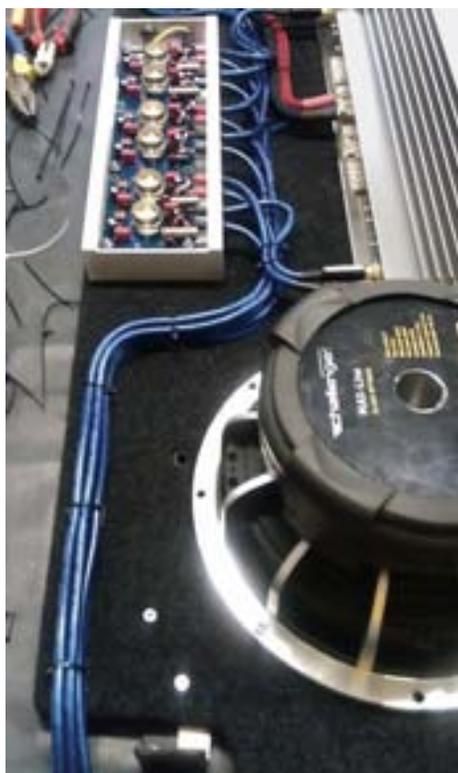
Межблочники впаяны в процессор напрямую, без разъёмов
