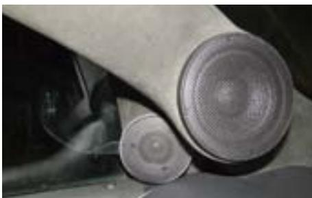
При закрытой двери фланец пищалки частично прячется за подиумом СЧ
