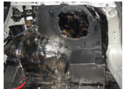
Корпус сабвуфера с «заёмом» позволил набрать нужный литраж
