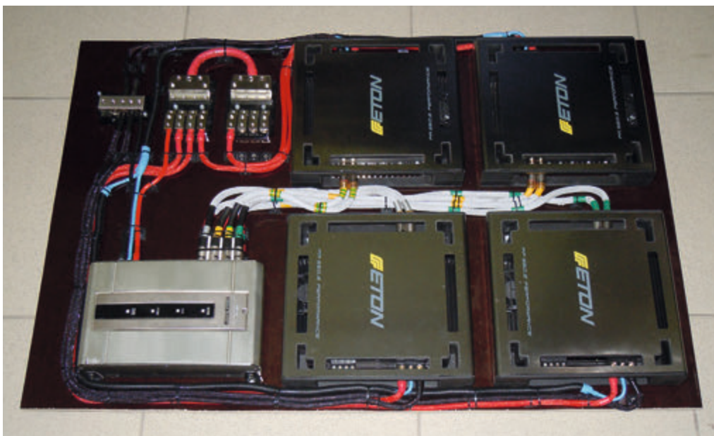
Все усилительно-процессорное хозяйство было собрано и скоммутировано до установки в багажник
