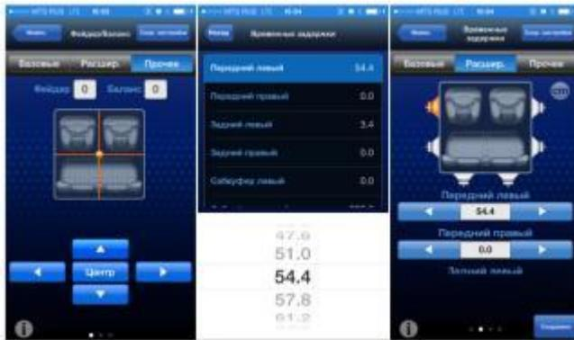
Настройка звукового поля возможна в двух вариантах. В первом, детсадовском – путём установки требуемого сочетания баланса и фейдера. Взрослый режим – это нормальные временные задержки по всем шести каналам, вводить которые можно по перечню каналов или по схеме салона.
