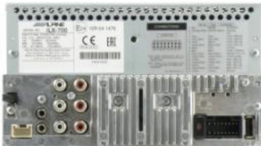
Тыл iLX-700. Слева – разъём объединённого интерфейса внешних устройств: вход камеры заднего вида, AV-вход, выход дистанционного управления устройствами Alpine, подключение CAN-адаптера (разъём UART). Правее – вход для подключения микрофона и датчика проводного дистанционного управления, ещё правее – три выхода предусилителя (фронт, тыл, сабвуфер).
