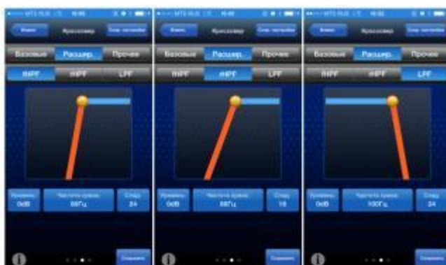
Фильтры регулируются отдельно по выходам (фронт-тыл-сабвуфер). Для фронта и тыла это ФВЧ с частотой среза от 20 до 200 Гц с крутизной 6 – 12 – 18 – 24 дБ/окт. для сабвуферного выхода – ФНЧ с такими же характеристиками.
