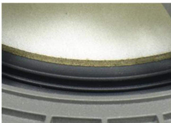
*Макросъёмка даёт представление об устройстве материала диффузора. Там, где «на паспорт» - кевларовый композит, с тыла – стеклопластик, между ними – пористый наполнитель Rohacell, употребляемый в современной авиапромышленности ровно с той же целью: чтобы было жёстко и легко одновременно. А вот что это за рубчики на резиновом гофре? Сейчас снова перевернём и посмотрим...*
