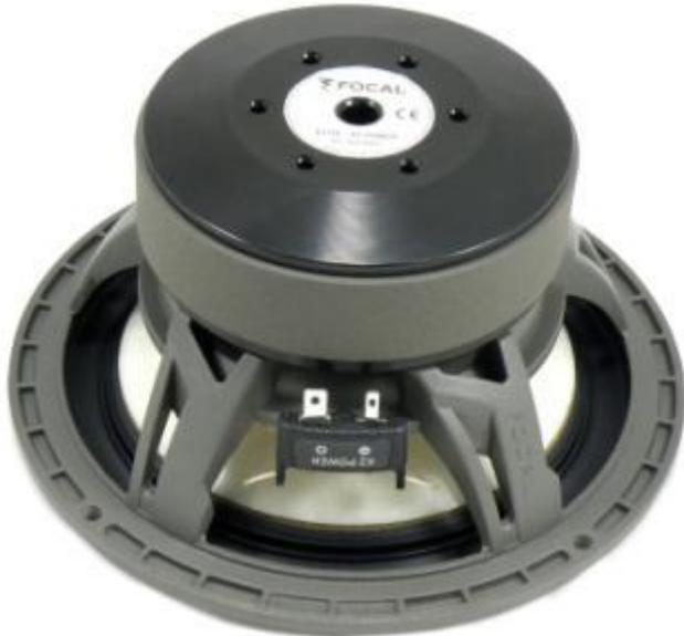
*С тыла уточнилось: корзина стала другой совершенно, тоже литой, но со спицами сложной формы. С магнита ушёл хромовый декор, зато появился второй контур системы вентиляции 40-миллиметровой звуковой катушки.*
