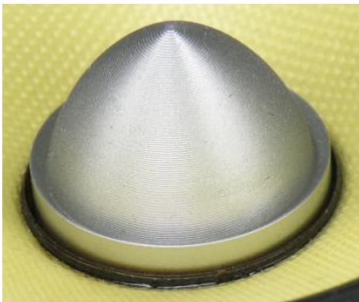
*«Пуля» здесь ни разу не дура. Поверхность проточена узкими, но глубокими треугольными канавками, по периферии (это, впрочем, было и в прошлой серии) некое подобие рва вокруг крепостной стены. И то, и другое – явно по акустическим соображениям, а не просто для красоты. Вот есть у нас такое убеждение.*
