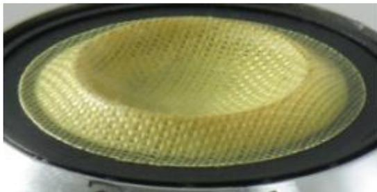
Снова подробности под микроскопом. Новая форма фокаловких куполов, называется «Профиль М». Действительно, похоже. В честь новой геометрии твитер получил и собственное имя: ТКМХ. Материалы – прежние, арамидная ткань на подвесе из фирменного материала Poreon (микропористый резиноподобный полимер).
