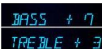
Простейшая, но всё-таки ручная, настройка – двухполосный тембр, вызывается вместе с балансом и фейдером кнопкой AUDIO в левом верхнем углу панели.
