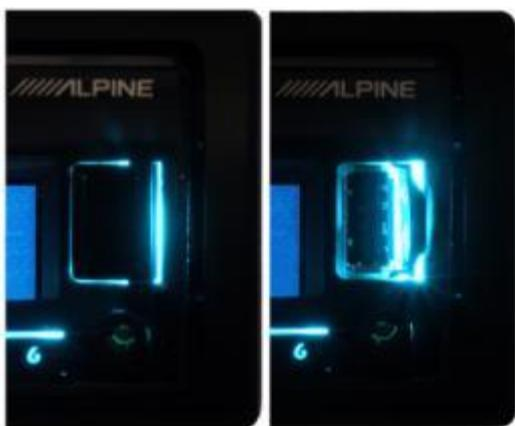
*Главный цифровой вход – порт USB, установлен остроумно: он подсвечен сбоку, поэтому сразу видно, открыта или закрыта непрозрачная дверца.*
