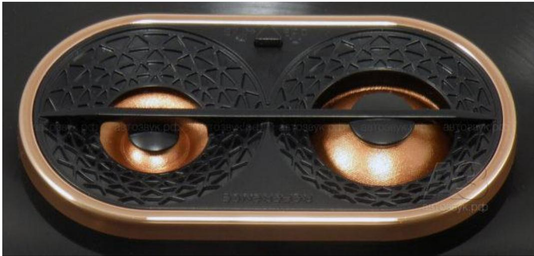
*Дополнительные излучатели крупным планом. Справа – обычный купол СЧ, слева – сбалансированный купол ВЧ. Заявка на 30 кГц подкреплена весомыми аргументами.*
