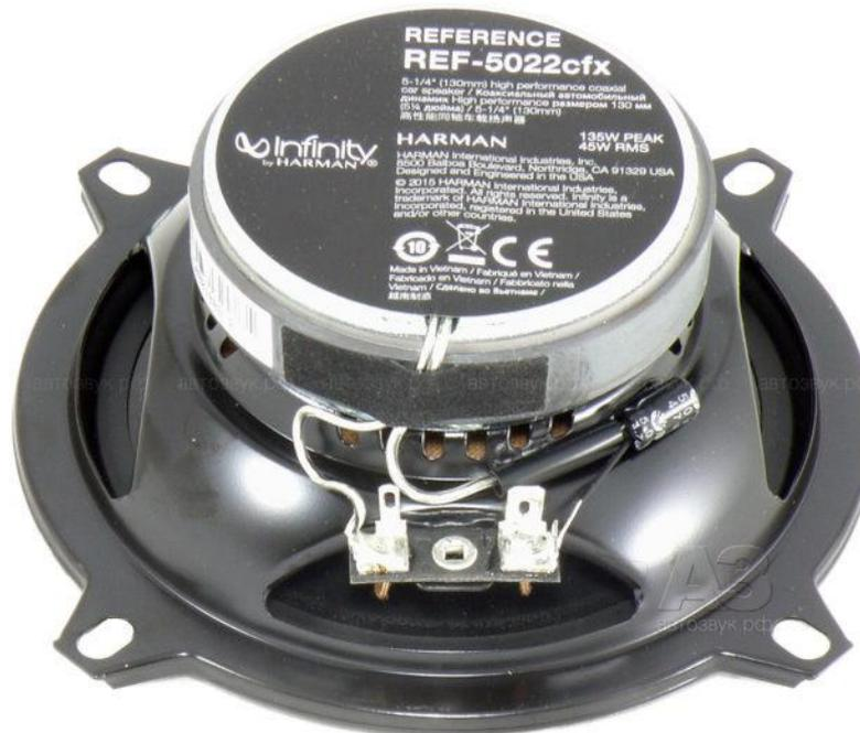
*Диффузородержатель штампованный, предусмотрено охлаждение звуковой катушки. Фильтр первого порядка (конденсатор 4,7 мкФ) смонтирован открыто. Клеммы-лопаточки достаточно надёжны.*
