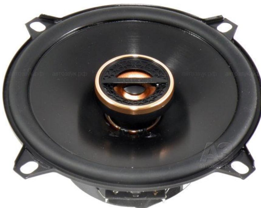
*PlusOne во всей красе. Прирост площади диффузора от применения этой технологии особенно заметен у динамиков небольшого калибра, там он может достигать 30%. Твитер с текстильным куполом снабжён коротким рупором и фазовыравнивающей системой с диском и спицей. Рельефный рисунок на поверхности рупора по замыслу разработчиков увеличивает дисперсию излучения.*
