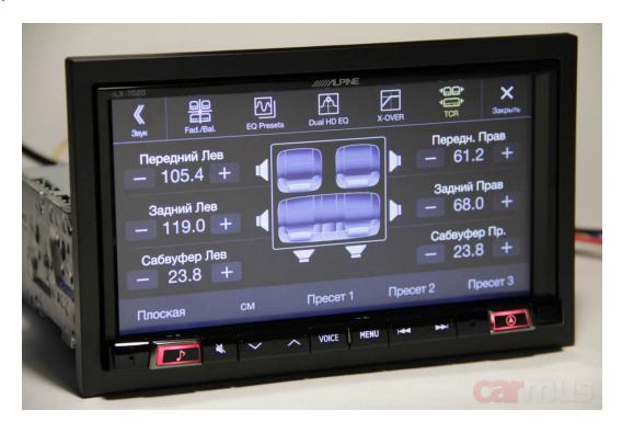
Эквалайзер назван Dual HD EQ. Судя по всему, потому, что пары каналов можно настраивать раздельно, а сам эквалайзер является 9-полосным параметриком — для каждой полосы можно выбрать центральную частоту и ширину полосы регулирования (узкую, среднюю, широкую).
