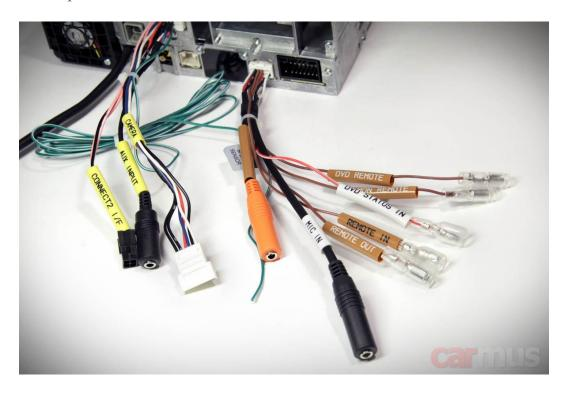
Разумеется, предусмотрена возможность управления и другими устройствами Alpine, для этого имеется целый пучок управляющих выходов для "общения" с ними. Скажем, TV-тюнер (Alpine TUE-T220DV) или отдельный DVD-проигрыватель (Alpine DVE-5300). В этом же "хвосте" проводов имеется разъём для подключения родной "алпайновской" фронтальной или тыловой камеры — она настраивается тоже из меню головного устройства.
