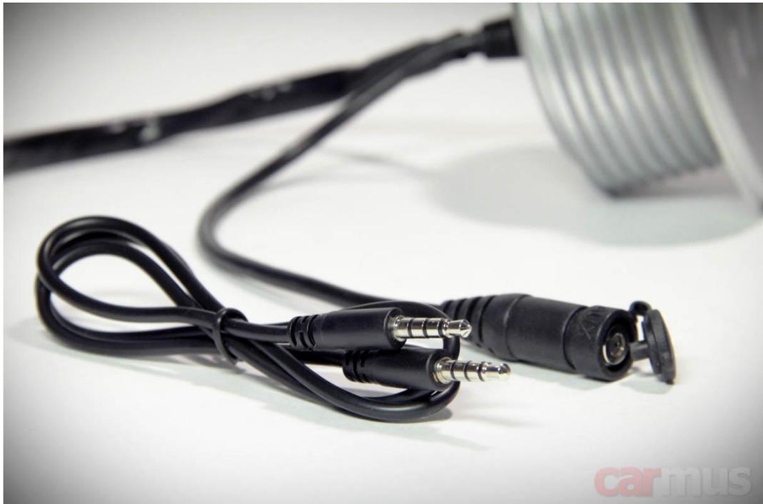
Теперь что касается самих подключений. Тут всё предельно просто – плюс и минус к бортовой 12-вольтовой сети и выходы на пару акустических систем. Ничего лишнего.
