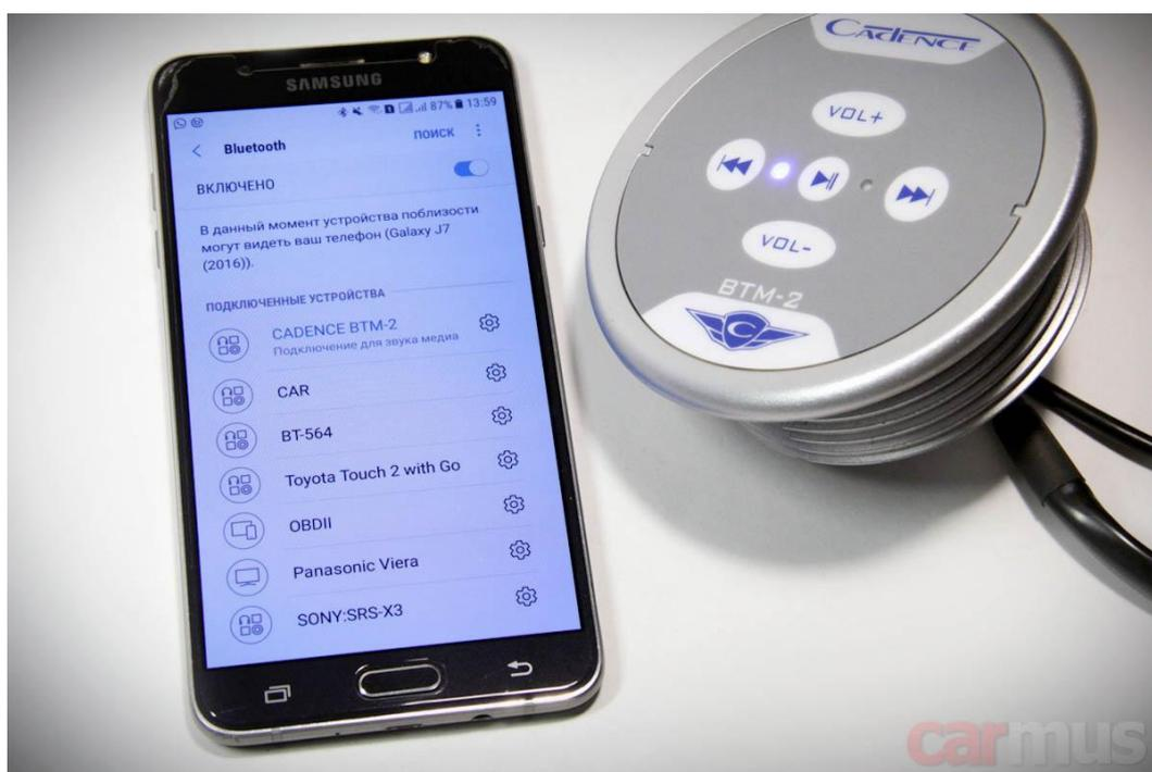
Режим работы виден по индикаторам. Если смартфон подключен по Bluetooth, то горит синий, если нет – продолжает гореть красный, и в это время задействован AUX-вход. Вообще, в приоритете у BTM-2 именно Bluetooth-источники – чтобы задействовать AUX, нужно разорвать беспроводное соединение.
