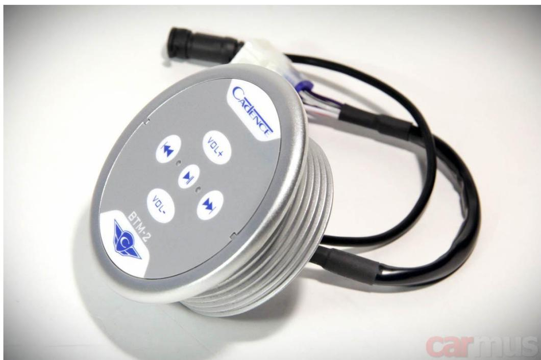
Размеры у VTM-2 совсем небольшие. Сам корпус имеет диаметр всего 8 см и высоту 4 см. Передняя панель чуть побольше – диаметром 10 см. Крепится очень просто – корпус вставляется в вырезанное отверстие, приклеивается на двусторонний скотч и зажимается с обратной стороны здоровенной пластиковой гайкой.
