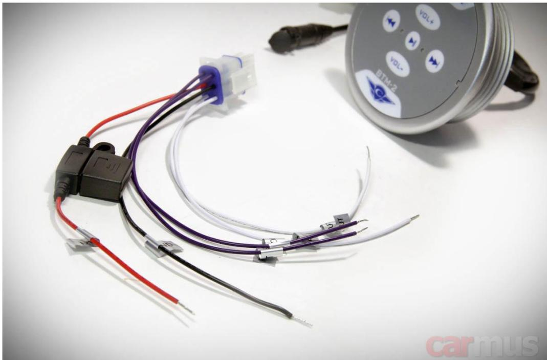
Отдельного провода АСС (как в обычных автомобильных головных устройствах) тут нет, так что нужно обратить внимание, к чему подключаться. Самый простой вариант – через релюшку, которая будет управляться сигналом с бортового АСС.
