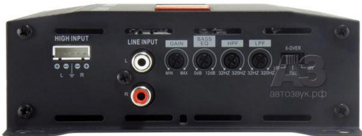
Сторона входов и регулировок. Предусмотрен линейный режим, отдельные ФНЧ и ФВЧ, перестраиваемые от 32 до 320 Гц и плавный бас-буст. Предусмотрен вход высокого уровня, для него в комплекте есть переходник. Ширина корпуса 145 мм, длина – 157 мм, высота – 50 мм
