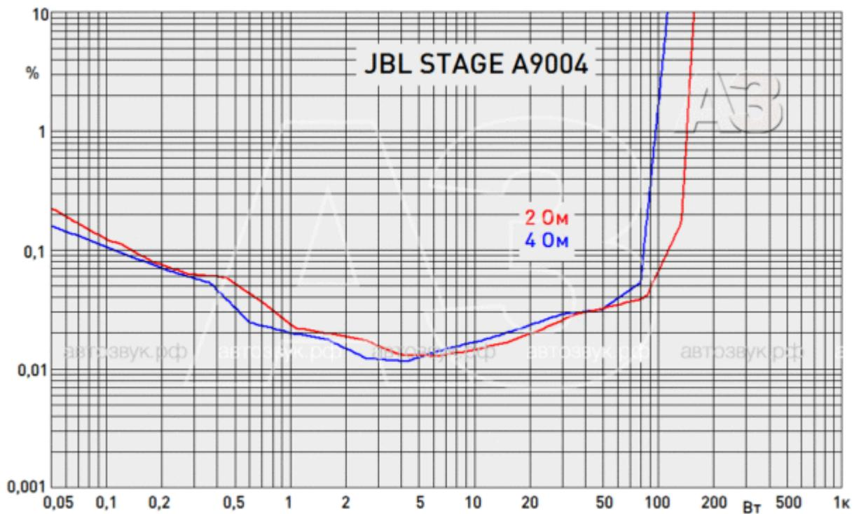
Для четырёхканального A9004 реальный прирост мощности при переходе к низкоомной нагрузке почти 40% (но, заметим, при испытании только одного канала). Уровень искажений от сопротивления нагрузки зависит мало, поэтому мостовое подключение нагрузки допустимо не только для сабвуфера, но и для широкополосной акустики. На микромощностях рост искажений не столь быстрый, как у A6002, а зона минимальных искажений существенно шире
