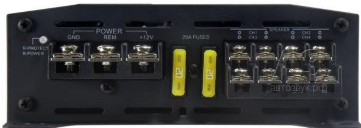
Со стороны «силового» торца пара вилочных предохранителей по 20 А, «двухэтажная» колодка для акустики
