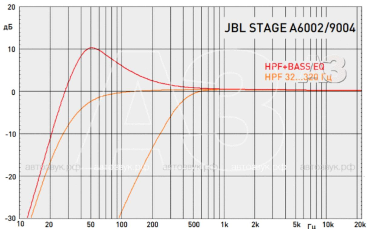
ФВЧ согласно заявке переставляется от 32 до 320 Гц, добротность с понижением частоты среза немного снижается. Совместное применение ФВЧ и бас-буста позволяет подправить АЧХ недостаточно басовитых динамиков без риска их перегрузки
