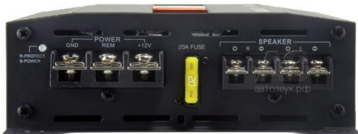
Со стороны «силового» торца вилочный предохранитель на 20 А, изолированные разъёмы под провода питания и акустики. Клеммы под «вилочки», винты под отвёртку
