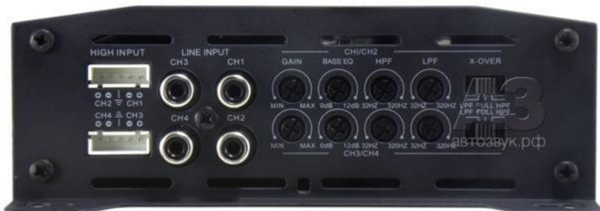
Ширина корпуса четырёхканального усилителя те же 145 мм, длина – 267 мм, высота – 50 мм. Оснащён он точно так же, с теми же пределами регулировки фильтров. Обе пары каналов идентичны, режим запараллеливания входов не предусмотрен – могут понадобиться Y-разветвители
