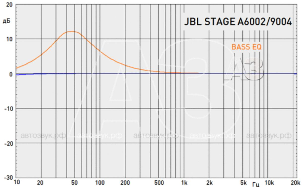
АЧХ линейна от 10 Гц до 20 кГц, с завалом по краям диапазона 0,2-0,5 дБ, что значительно перекрывает заявку. Бас-буст, названный «басовым эквалайзером», работает и в широкополосном режиме, что может быть полезным
