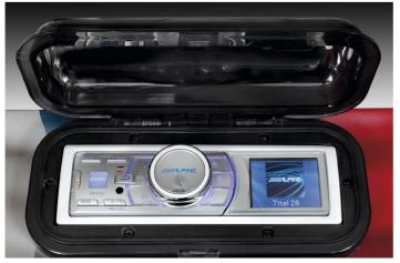
Защита головного устройства обеспечивается боксом с герметичной крышкой
