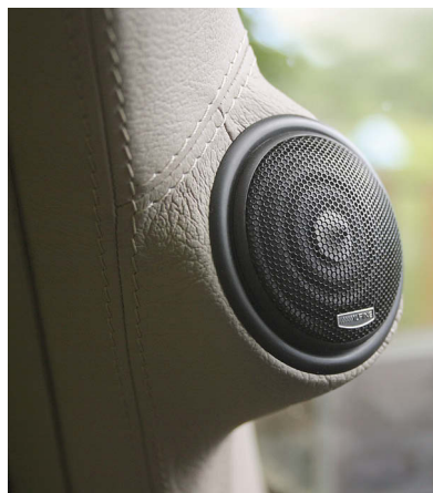
В ходе развития системы все пищалки стали кольцевыми из комплекта Alpine SPX 17PRO
