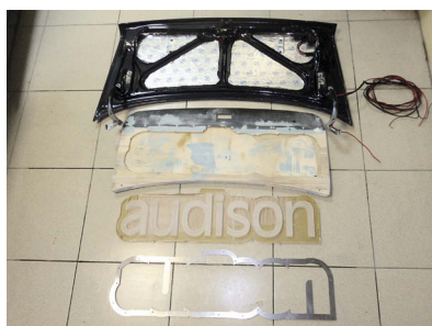
Сборка светящегося логотипа на крышке багажника
