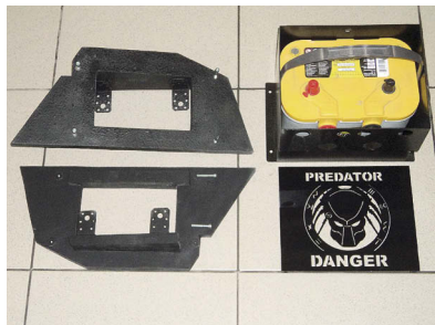
Для всех трёх аккумуляторов изготовлены металлические боксы с крышками
