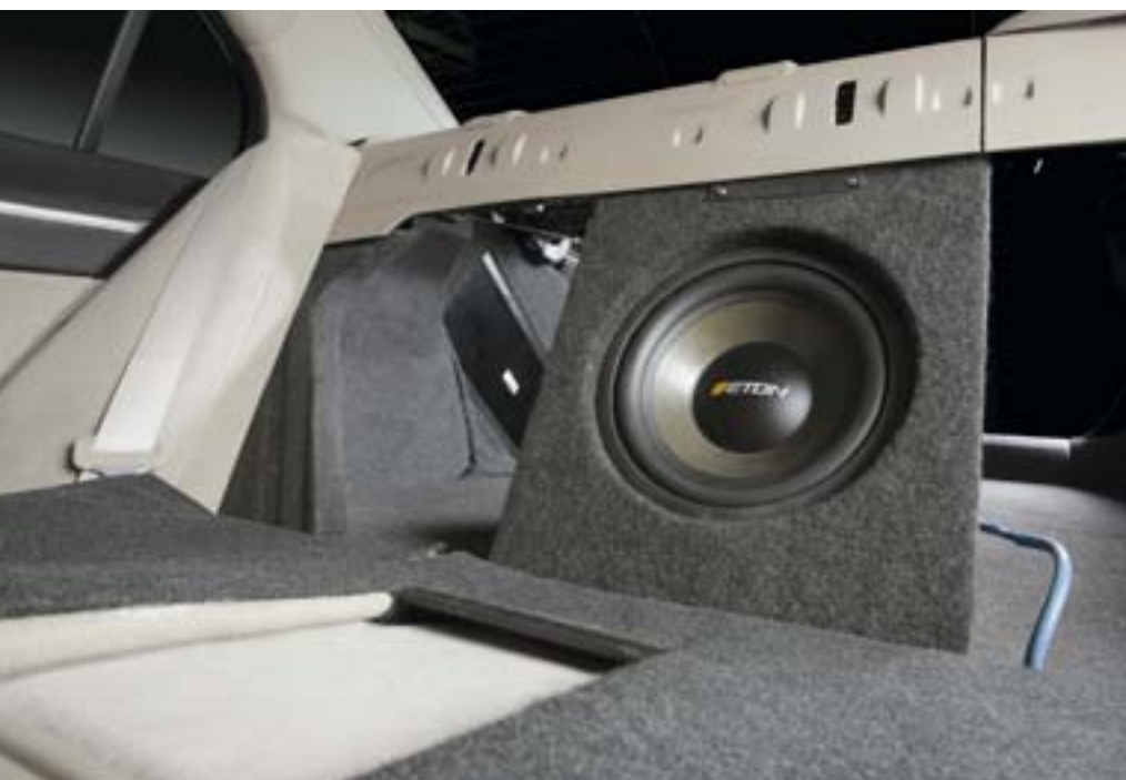
Корпус сабвуфера сделан мощным по кругу, а передняя панель — трижды мощной
