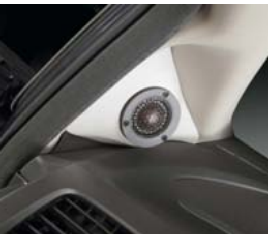
«Датская горошина», установленная в оконных «микропроёмах», работает с плоскости, в наилучших условиях
