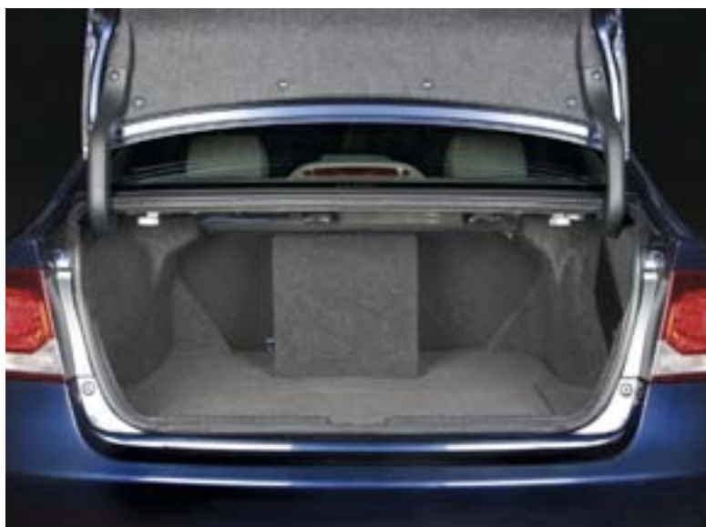
Сабвуфер-тумбочка — плод техзадания, справа и слева от него можно по-прежнему возить длину
