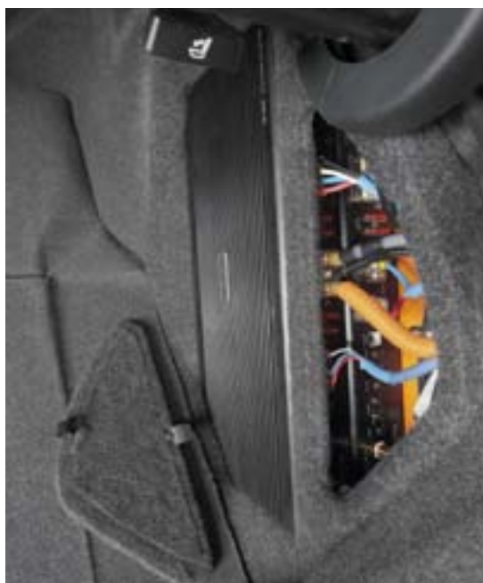
Установленный на краю монтажной панели вентилятор дует сразу на всю стопку компонентов
