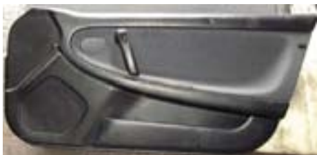
Штатные обивки. С виду нормальные, за время простоя машины истлели внутри
