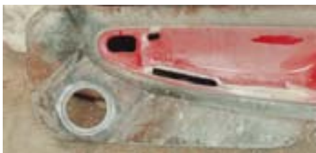
Новые обивки, полностью из стеклопластика, выклеены по матрицам, а матрицы сняты со штатных
