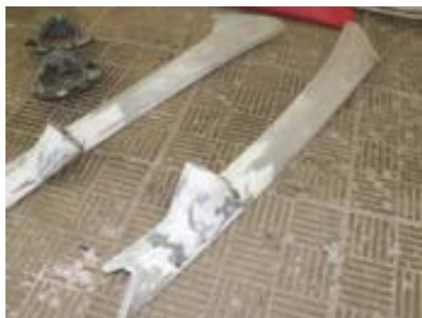
Стеклопластиковые корпуса для СЧ и ВЧ-головок
