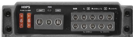
Акустика и remote принимает провод диаметром до 6 мм, силовые — до 8 мм
