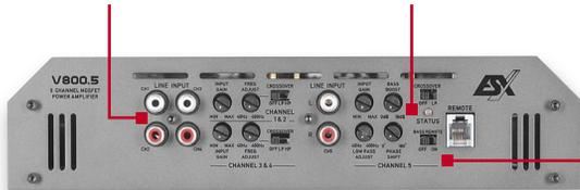
Все соединители под «лопаточки». Акустика и remote шириной 8 мм, сила — 12 мм
