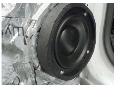
Вокруг установленного мидбаса — толстое звукопоглощающее кольцо
