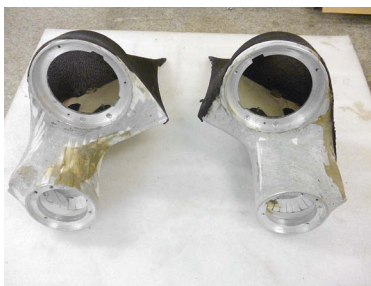
Лицевая поверхность сформирована узкими пластиковыми полосками, поверх которых — стеклоплатёвка
