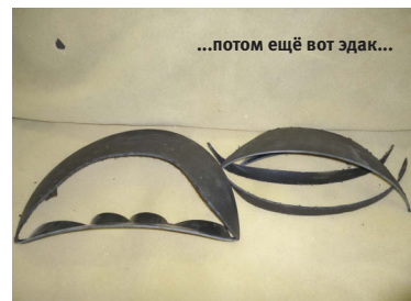
...прорези в немецком ABS зашиваются московским стеклопластиком...
