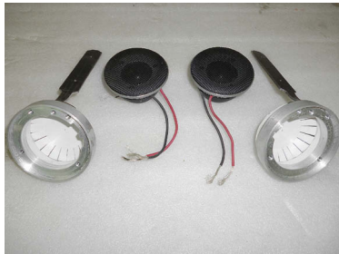
Пищалки и кольца с кронштейнами для них, сзади на кольцах шаблоны, обозначающие глубину, чтобы не промазать при выклейке
