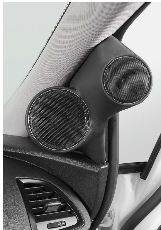
А главным во всей этой затее было обеспечить СЧ и ВЧ-головкам найденное опытным путём единственно правильное взаимное положение
