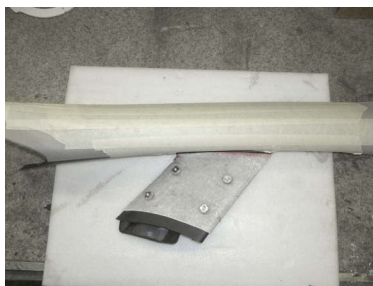
«Лететь с одним крылом...» Нет, крыло тут ни при чём: это к стойке прикреплена опорная площадка для будущих СЧ/ВЧ-подиумов
