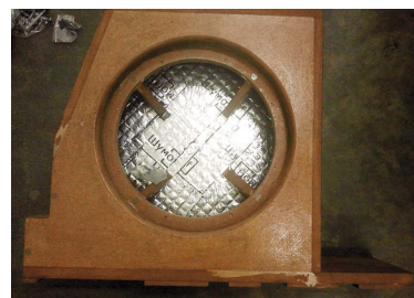
Жёсткость жёсткостью, а виброобработку пока никто не отменял
