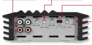
Отдельный светодиод сигнализирует о включении и о нештатной ситуации
