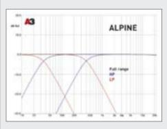
Фильтры сделаны без затей, но безукоризненно: характеристики у всех — строго второго порядка, пределы регулировки частоты среза — от 35 до 400 Гц (по разметке на панели управления — от 30 до 400. Поводов для недовольства, что недодали, не вижу). При отключённых фильтрах вблизи нижней границы исследованного частотного диапазона спада АЧХ нет (вот просто тупо нет), на 20 кГц есть — целых 0,4 дБ
