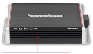
Право «Рокфорда» на титул «компактный» сомнений не вызывает, при этом корпус и литые законцовки задуманы и выполнены стильно и оригинально. У корпуса, например, верхняя сторона не плоская, а вогнутая (видно на фото с торцев). Габариты корпуса указаны при выдернутых соединительных колодках, но с учётом крепёжных фланцев, что приводит к такому же результату, как если бы колодки установить на свои места
