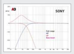
Фильтры, как вы поняли по органам управления, фиксированные, частота среза у обоих — почти точно 80 Гц, крутизна — 18 дБ/окт. Бас-буст — аккуратный, 10 дБ (даже чуть меньше) на 43 Гц и в довольно широкой полосе вокруг этой частоты. При выключенных фильтрах полоса пропускания отменно широкая: спад на низах почти отсутствует (-0,3 дБ на 10 Гц), на 20 кГц он также составляет меньше полдецибела.
