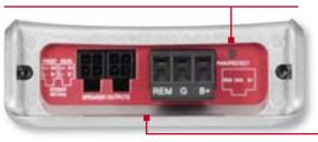
На «силовой» панели — выходные разъёмы (идентичные входным) и съёмная кололка питания все тои гнезда в которой — под провод диаметром до 3 мм. Предохранитель на 30 А рекомендовано включать в разрыв плюсового провода
