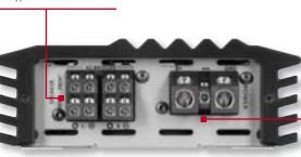
Для подключения питания и Remote служит отдельная колодка: провода питания могут быть до 8 мм в диаметре, Remote — до 4 мм. Щедро... Встроенного предохранителя нет
