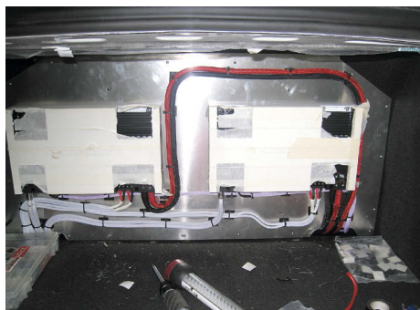
Со стороны багажника вертикальная стенка зашита листом алюминия
