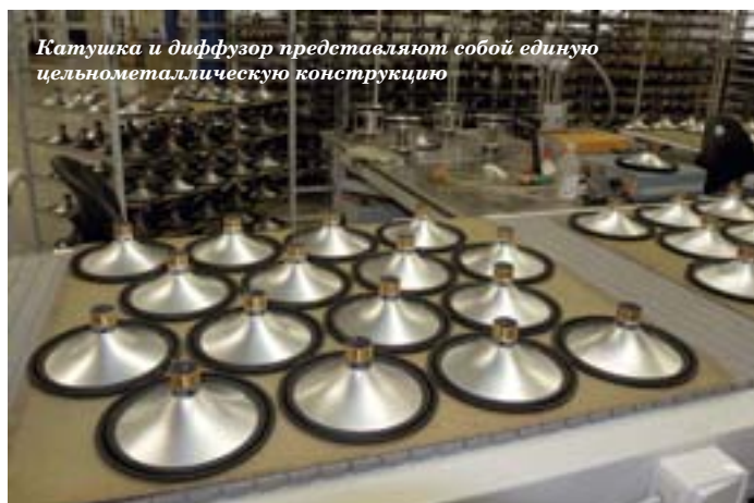
Сборка магнитных систем. Справа видны блоки с технологическими центрующими втулками
