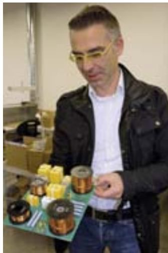
Франк Гёбл демонстрирует кроссовер для топовой колонки Reference
