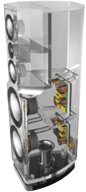
В кроссоверах, выполненных из отборных элементов, используется фирменная технология Displacement Control, препятствующая инфранизким колебаниям диффузоров
