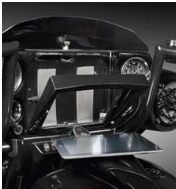
iPad крепится за откидной рамкой, запирающейся на ключ
