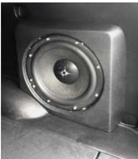
Полная готовность. Раскрой фальшпола багажника скрывает «заёмную» часть корпуса
