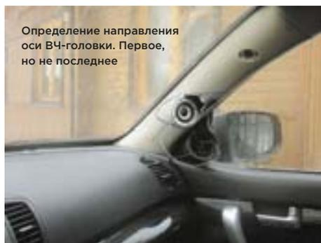
Определение направления оси ВЧ-головки. Первое, но не последнее
