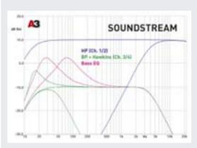
АЧХ вновь размечены по полю графика. В каналах 1 — 2 постоянно включён ФВЧ с пределами перестройки частоты среза 15 Гц — 4 кГц, строго как заявлено. В каналах 3 — 4 ФВЧ такой же, да не такой: при любой частоте среза регулятором Хоукинса можно менять добротность фильтра (в плюс), на АЧХ это выражается в регулируемом «подбросе» АЧХ вблизи частоты среза. Независимо от этого работает басовый эквалайзер с центральной частотой от 28 до 75 Гц по измерениям.
