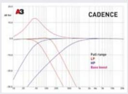
ФНЧ даёт стабильные АЧХ при изменении частоты среза от 60 до 180 Гц (таковы измеренные пределы), с ФВЧ дела несколько хуже: фактический верхний предел частоты среза составляет 600 Гц, но задолго до приближения к нему крутизна фильтра падает с изначальных 12 до примерно 7 дБ/окт. Бас-буст даёт подъём до 12 дБ на 45 Гц.
