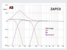
Второй участник с фильтрами 4-го порядка, пределы регулировки частоты среза — ровно как заявлено и размечено, несмотря даже на присутствие на АЧХ в полной полосе остатков бас-буста. Сам буст настроен на «американскую» частоту 50 Гц, на которой даёт подъём до ровно 12 дБ.
