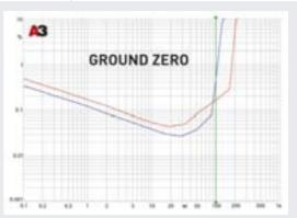
Мощность «водородника» — как требовалось по условиям теста, более 100 Вт на 4 Ом. При 2-омной нагрузке прирост мощности составляет 66%, это говорит о неплохих токовых резервах, сабвуферу скучать не придётся. Искажения — не безумно низкие, на малой мощности (условный «первый ватт») они переходят через границу (тоже условную) 0,1%.
