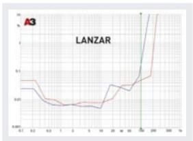
Небольшой по габаритам Lanzar легко перешагивает за зелёную линию на 4-омной нагрузке, на 2 Ом и 200 Вт для него не становится препятствием. Зависимость искажений от мощности типична для современных (ключевое слово) импульсных усилителей: рост нелинейностей предваряет насыщение, в зоне рабочих (и микро-) мощностей искажения завидно низкие.
