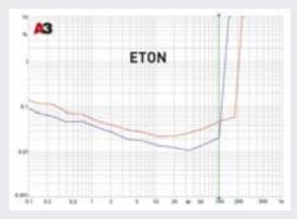
План по мощности Eton выполняет, на 2-омной нагрузке даже аккуратно перешагивая через 200-ваттную отметку, без фанатизма, однако. Нелинейные искажения и в рабочем диапазоне выходной мощности, и на «первом ватте» низкие, безоговорочно.
