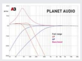
У «Анархии» обнаружились широкая полоса и вполне работоспособный ФНЧ с крутизной 12 дБ/окт. (при несколько меняющейся добротности и пределах перестройки 50 -120 Гц), чего должно хватить в любой нормальной системе.  $\Phi$ ВЧ — намного хуже, при частоте среза, существенно выше минимальной (это 55 Гц), крутизна спада уменьшается, стремясь к 6 дБ/окт. Бас-буст даёт подъём до +17 дБ на центральной частоте 42 Гц
