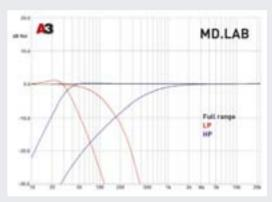
Номинальная крутизна характеристики ФНЧ составляет 18 дБ/окт., но из-за меняющейся при регулировке добротности фильтра это не так просто заметить. Верхний предел частоты среза по факту составляет 90 Гц. У ФВЧ крутизна 12 дБ/окт. снижается по мере роста частоты среза.
