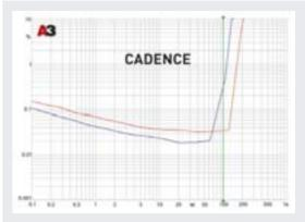
Зависимость искажений от выходной мощности — одна из типовых разновидностей «коленки», характерной для усилителей класса АВ. Мощность на 4 Ом — в соответствии с нашим техзаданием, при переходе на 2 Ом она возрастает на 45%. Больших резервов по току в усилителя нет, но и мало, скорее всего, не будет. Искажения достаточно низкие.
