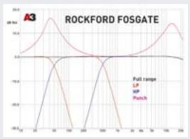
RF — один из двух в этом тесте усилителей с фильтрами 24 дБ/окт. Оба работают безупречно, пределы регулировки частоты среза — точно по заявке. Панч-регулятор — нововведение небесспорное, поскольку верхние частоты поднимаются одновременно с нижними, но такие АЧХ мы не раз видели в готовых системах, так что почему бы и нет...
