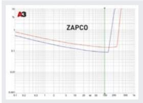
Не обделённый мощностью на нагрузке 4 Ом, на 2-омной Zарсо единственный в этом тесте сумел чиркнуть об отметку 300 Вт. К сожалению, выдающиеся показатели мощности здесь сочетаются с не самыми низкими цифрами нелинейных искажений, особенно на самой малой мощности.
