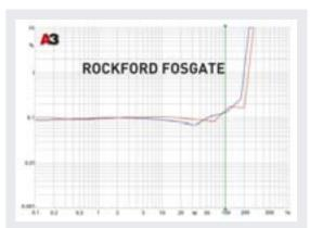
«Рокфорд» давно экспериментирует с гибридной схемотехникой, вот и здесь применено усиление в неведомом классе AD. Итог экспериментов: мощность оказалась близкой на разной нагрузке, при этом неизменно внушительной. Кривая искажений ведёт себя необычно: нелинейности почти при любом значении выходной мощности равны 0,1% или чуть ниже. Чудны дела твои..
