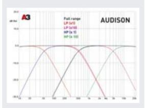
Нижний предел регулировки частоты среза у обоих фильтров чуть выше заявленного — 52 Гц вместо 50, простим? К тому же больше придраться не к чему: промежуточный (500 Гц) и верхний (5 кГц) пределы выдержаны аптекарски, а поддиапазоны состыкованы бесшовно. Крутизна фильтров (12 дБ/окт.) и добротность абсолютно неизменны.
