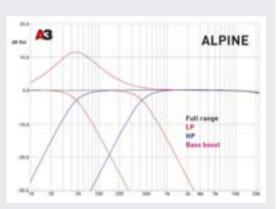
Фильтры у Alpine - как шкаф из морёного дуба: строго и с достоинством. Пределы перестройки частот среза обоих фильтров чуть шире заявленных -45-430 Гц. АЧХ безупречно стабильны, бас-буст широкополосный, такой прибавляет «мяса», не провоцируя бубнения на центральной частоте
