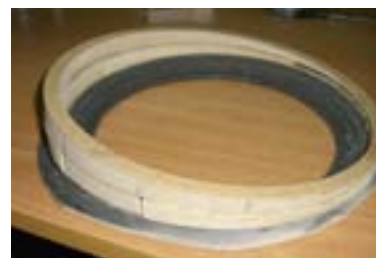
Рабочий момент: изготовление переходных колец под «неметрические» динамики
