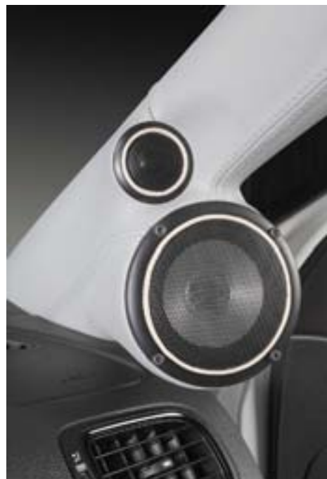
СЧ/ВЧ-узел сделан компактным, с мидрейнджем на «приставном месте»
