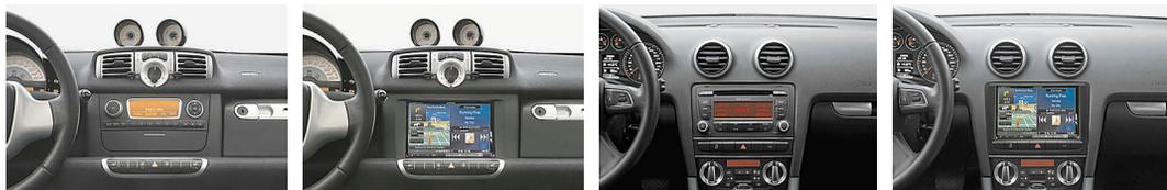
С первой 8-дюймовой моделью, INE-W928R, Alpine накопила опыт интеграции нестандартных головных устройств в самые разные машины. Вот результат инсталляции INE-W928R в Smart и Audi A3 с помощью фирменных установочных наборов
