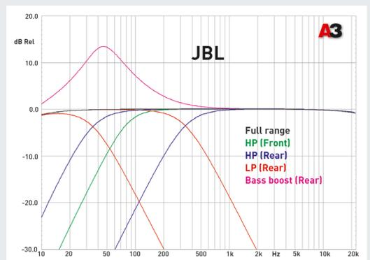
Всё, что обещали — положили. В одной паре каналов ФВЧ, действительно, на 80 Гц, в другой — полный набор, частота среза — от 32 до 320, крутизна 12 дБ/окт., ничего при регулировке не сползает. Буст широкополосный с фиксированным подъёмом на 13 дБ.
