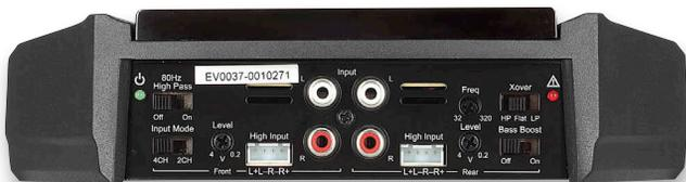
На панели входов и регулировок ничего лишнего. Об ориентации на схему «фронт + саб» говорит фиксированный ФВЧ во фронтальной паре каналов и бас-буст в тыловой. По центру панели — две пары линейных входов RCA и входы высокого уровня. Слева — фронтальные каналы, справа — тыловые
