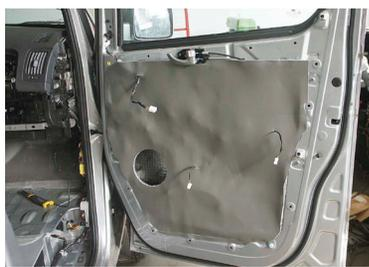
Поверх виброизоляции положили шумоизоляцию
