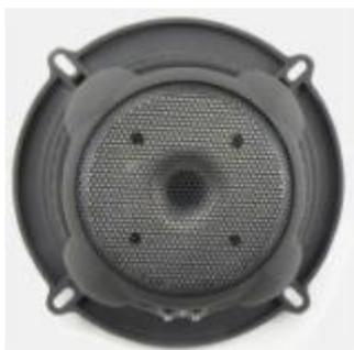
*Вид сзади даёт представление о геометрии корзины и устройстве вентиляции звуковой катушки: центральный канал в керне магнитной системы и четыре отверстия, выходящие в зазор. По тому, как они расположены, легко заключить о диаметре звуковой катушки. Да, 50 мм.*
