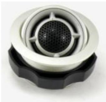
Главный наряд – чашки с креплением гайкой. Пищалка в чашке может качаться на 30 градусов в каждую сторону, но – в одной плоскости. Изменить плоскость можно, повернув чашку в установочном отверстии.
