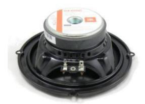
Корзина мидбаса — стальная штампованная, благодаря сложному и глубокому рельефу элементов жёсткости она получилась очень глухой. Помимо «расклешённого» отверстия в магнитопроводе, вентиляцию звуковой катушки обеспечивают окна в корзине под плоскостью центрирующей шайбы.
