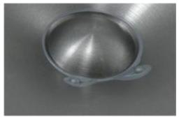
Центральный колпачок диффузора изготовлен «из того же материала» и скреплён щедрым клеевым швом одновременно и с диффузором, и с каркасом звуковой катушки.
