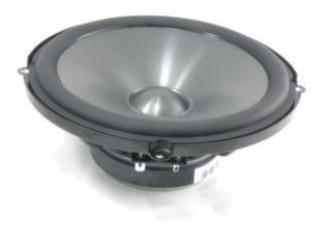
Главнейшая деталь двухполосного компонентного набора, разумеется — мидбас. Излучающая поверхность у него — неглубокого профиля диффузор из полипропилена со слюдяным наполнителем. То, что со слюдяным — видно совсем безоружным глазом, то, что неглубокий — непременно скажется на установочной глубине головки и, возможно, будет заметно на АЧХ. А может — и не будет, всякое бывает.
