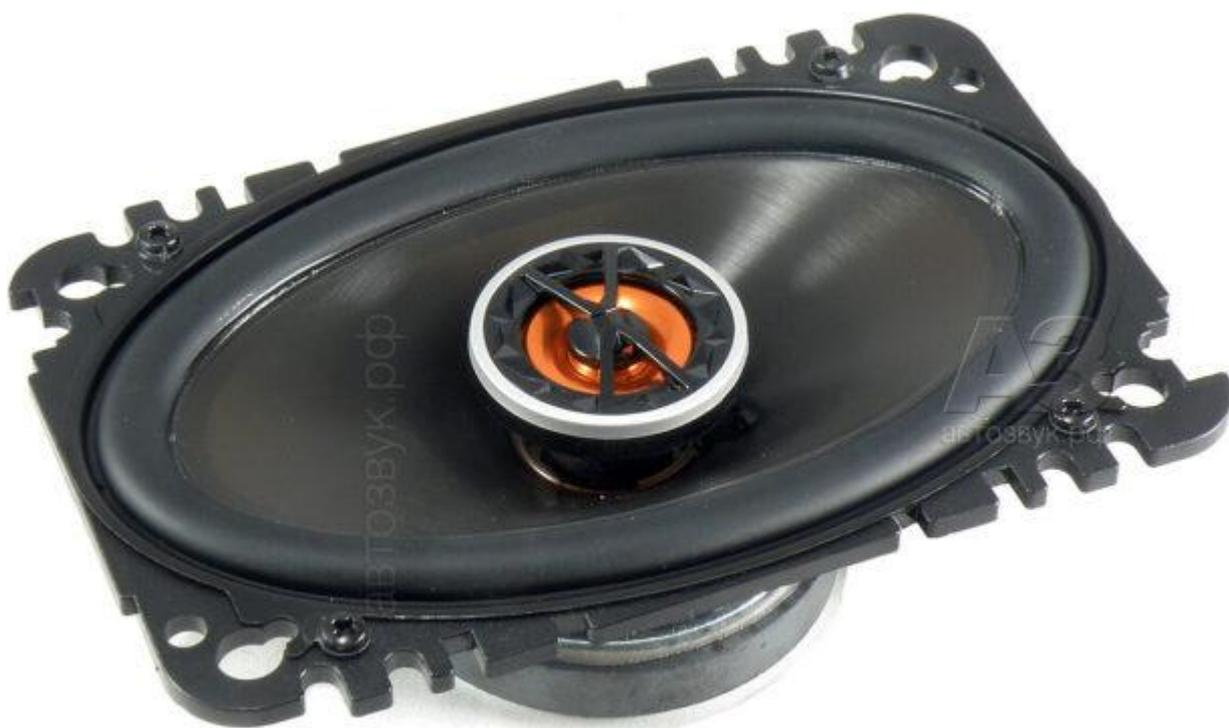
Уже упоминавшаяся «фордовская» модель JBL Club 6420 калибра 6 х 4 дюйма. Установочный адаптер за счёт своей толщины уменьшает посадочную глубину до 44 мм. Максимальная мощность 105 Вт, чувствительность 91 дБ, полоса частот 75 Гц — 20 кГц.
