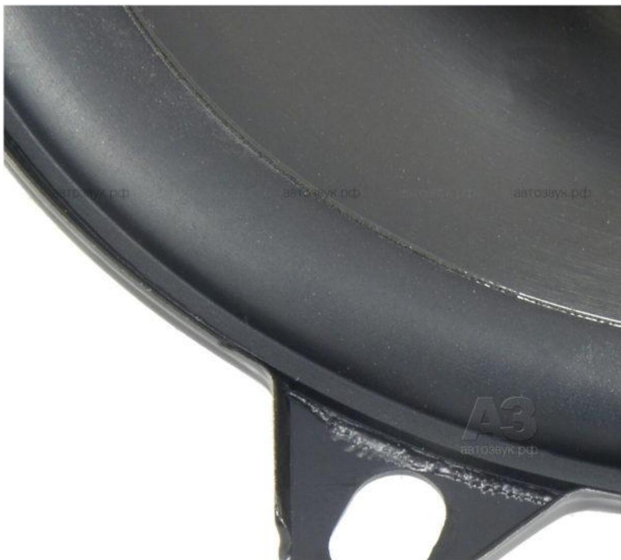
*Вот крупно гофр одной из моделей (5-дюймовой). Здесь использована фирменная технология Plus One, унаследованная от GTO. Суть дела в том, что за счёт изменения способа крепления внешнего края резинового гофра на фланце корзины увеличивается полезная площадь диффузора. А мы знаем: больше площадь – больше чувствительность.*
