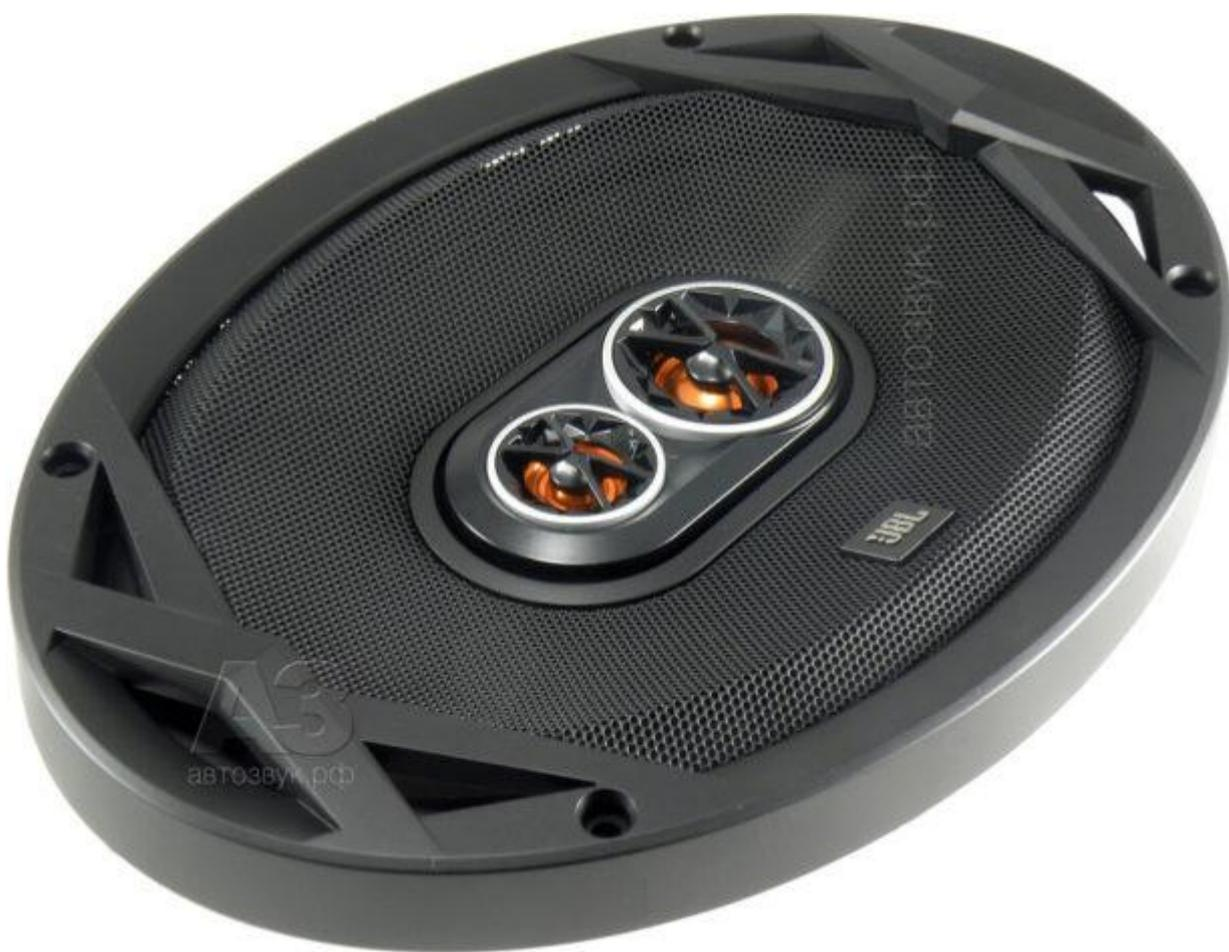
Самый представительный член клуба: трёхполосный JBL Club 9630 типоразмера 6 x 9 дюймов. Здесь в комплекте и сетка, и проставочное кольцо, позволяющее при необходимости уменьшить посадочную глубину с исходных 78 до 68 мм. Пищалок две: с куполами 22 и 18 мм. Максимальная мощность 240 Вт, чувствительность 93 дБ, полоса частот 50 Гц — 20 кГц.
