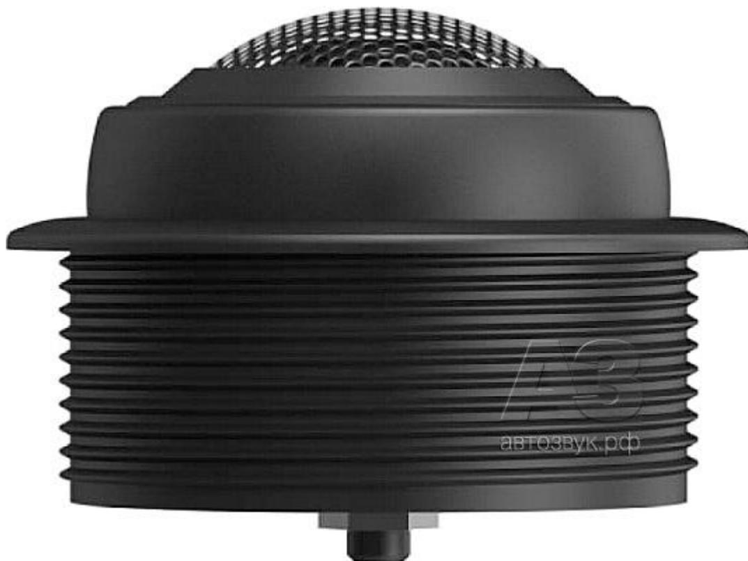
*Применяемая в комплекте Club 6500С пищалка Club 750Т поступает в продажу и как отдельный компонент, в традициях фирмы корпус снабжён резьбой для крепления к облицовке гайкой, а сам твитер может поворачиваться в корпусе на некоторый угол.*
