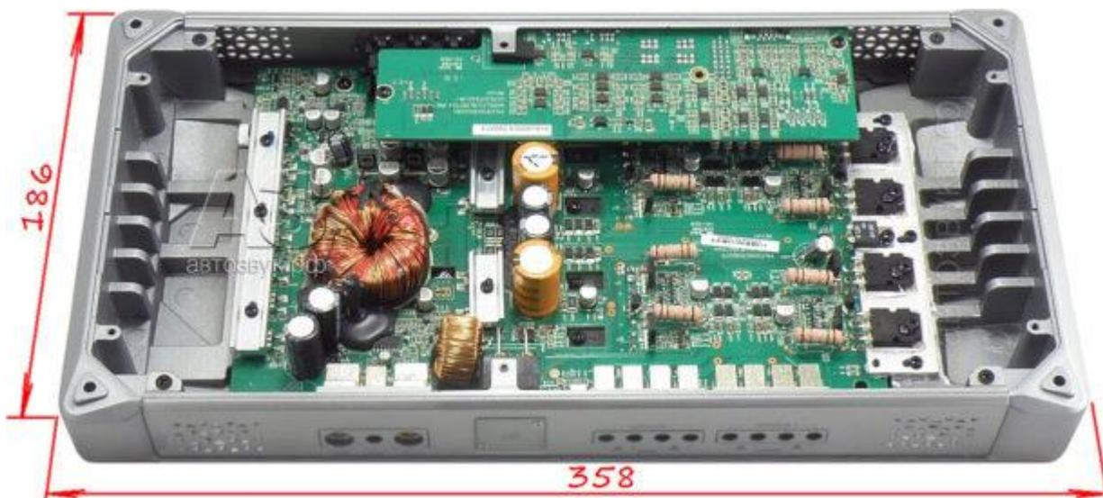
*Усилитель работает в классе АВ, поэтому габариты вполне отвечают традиции. Топология необычная – транзисторы одной пары каналов расположены традиционно, по краю платы. А транзисторы другой пары спрятались под платой и видны через квадратные окна (рядом с конденсаторами фильтра). Вторым этажом на отдельной плате – кроссовер.*
