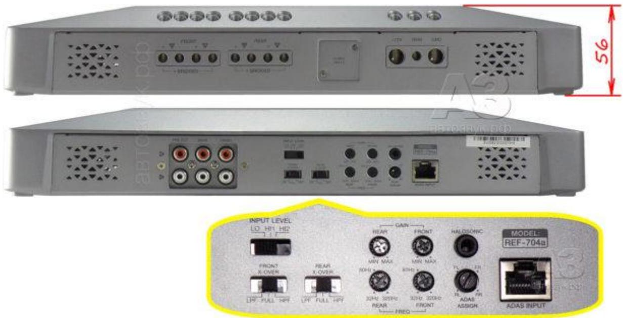
*«Силовой» край корпуса: ничего необычного, разве что предохранители аккуратно спрятаны под крышку. Полностью и целиком защищённые и изолированные гнёзда питания и акустики рассчитаны на провод диаметром 10 и 5,5 мм соответственно, зажимные винты под крестовую отвёртку. Со стороны, посвящённой входам и регулировкам, расположены две пары RCA входов и одна пара выходов (на неё приходит сумма сигналов фронта и тыла), и панель с регулировками.*
