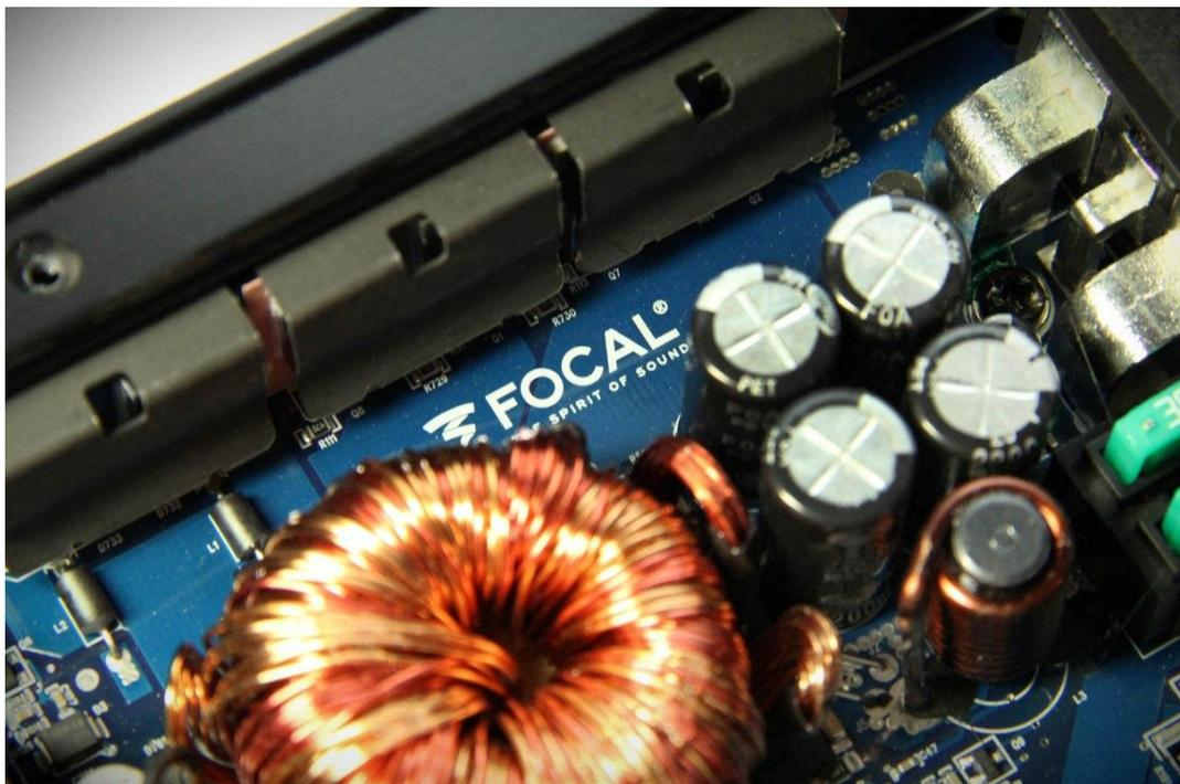
Львиную долю внутреннего пространства корпуса занимает блок питания. Ключи и диодные мосты расположились вдоль длинной стороны корпуса, задающий генератор вынесен на маленькую субплату. Тут всё логично, по делу и без сюрпризов.
