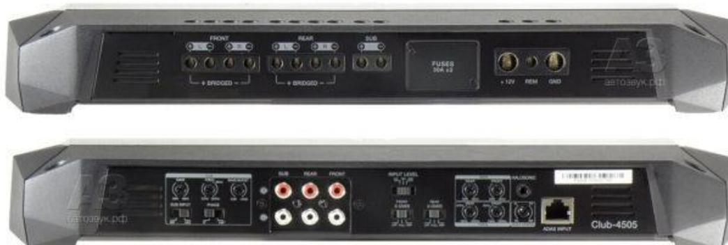
«Силовая» сторона корпуса выполнена в современных традициях: три предохранителя по 30 А упрятаны под крышку, изолированные гнезда питания и акустики рассчитаны на провод диаметром 10 и 5,5 мм соответственно, зажимные винты под крестовую отвёртку. С противоположной стороны – три пары RCA входов и панель регулировок, к ней мы вернёмся чуть позже.
