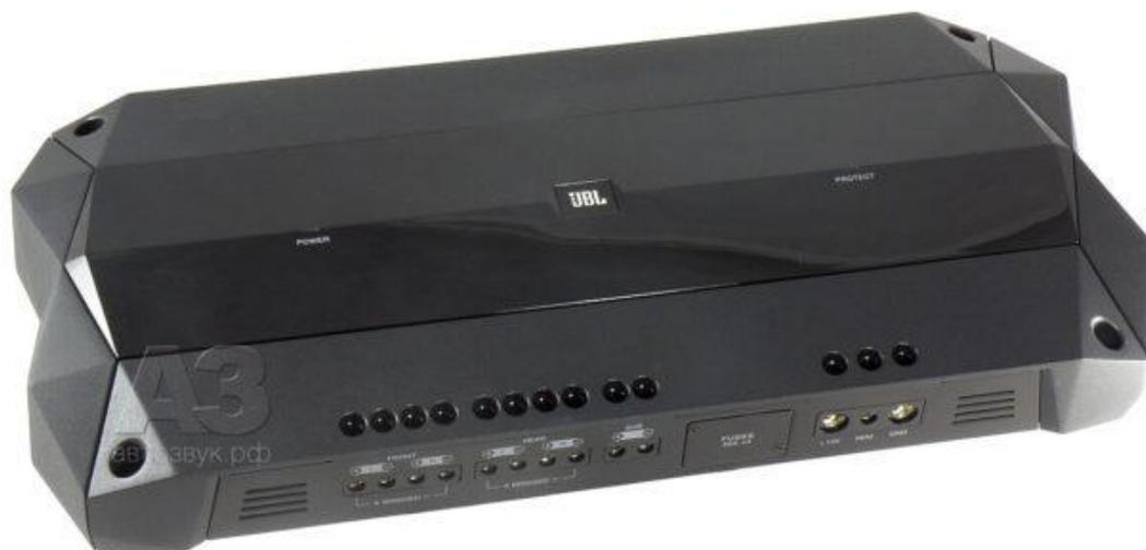
Массивный угловатый корпус хорошо отводит излишки тепла. Он литой, без единого шва, снизу и с боков закрыт панелями из листовой стали. Большая вставка из тёмного оргстекла придаёт усилителю нарядный вид. Высота корпуса по «гребню» декоративной вставки 59 мм, кромки почти на 10 мм ниже, углы – ещё ниже.
