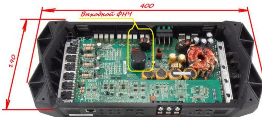
Для заявленной мощности усилитель весьма компактный – несмотря на то, что в импульсном классе D работает только канал сабвуфера. Четыре основных канала работают в классе АВ. Солидную часть платы занимает источник питания, вторым этажом на отдельной плате – часть каскадов предварительного усиления и обработки сигнала.
