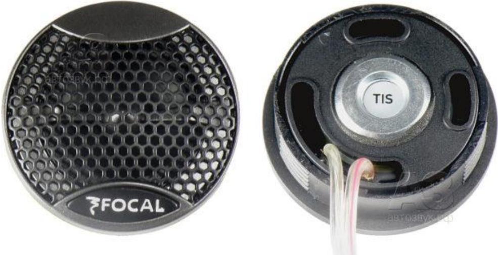
Пищалка с вогнутым алюминиевым куполом 25 мм и неодимовым магнитом снабжена фазовыравнивающей «пулькой» на поперечной спице и сеткой. Её можно установить либо в накладную цилиндрическую чашку (она видна на фото в заголовке), либо в фасонную «фару».
