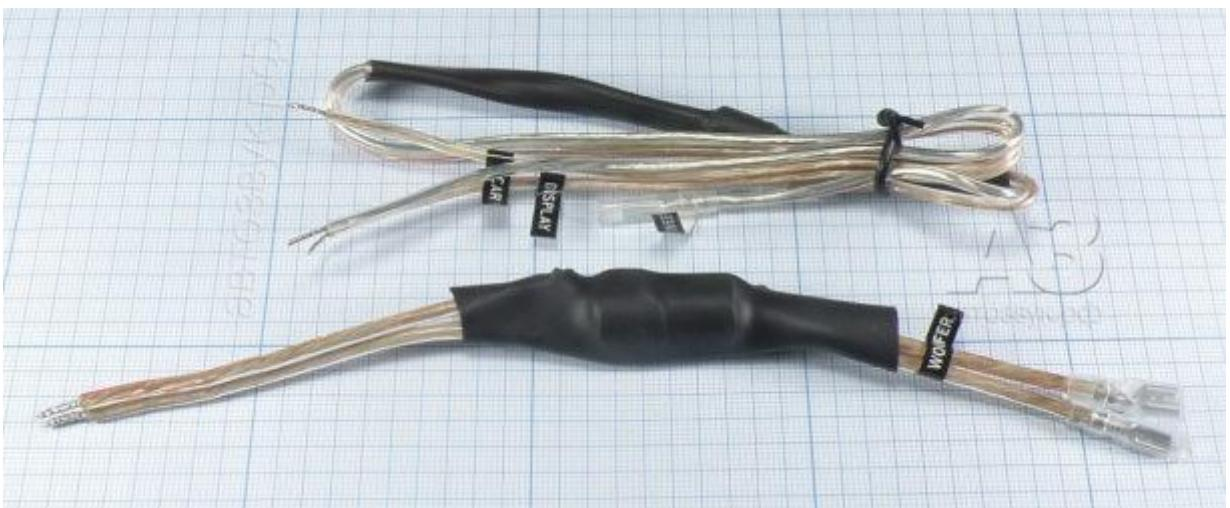
Кроссовер раздельно-интегрированный. Раздельный для пищалки и мидбаса и интегрированный – каждый в свой провод, что намекает, кстати, и на вариант с би-ампингом. Неразрушающие методы контроля показали, что все фильтры первого порядка, но в кроссовере пищалки предусмотрен дополнительный «демонстрационный» вход DISPLAY. На самом деле это второй конденсатор на другую частоту среза. При замерах выясним, что это даёт.
