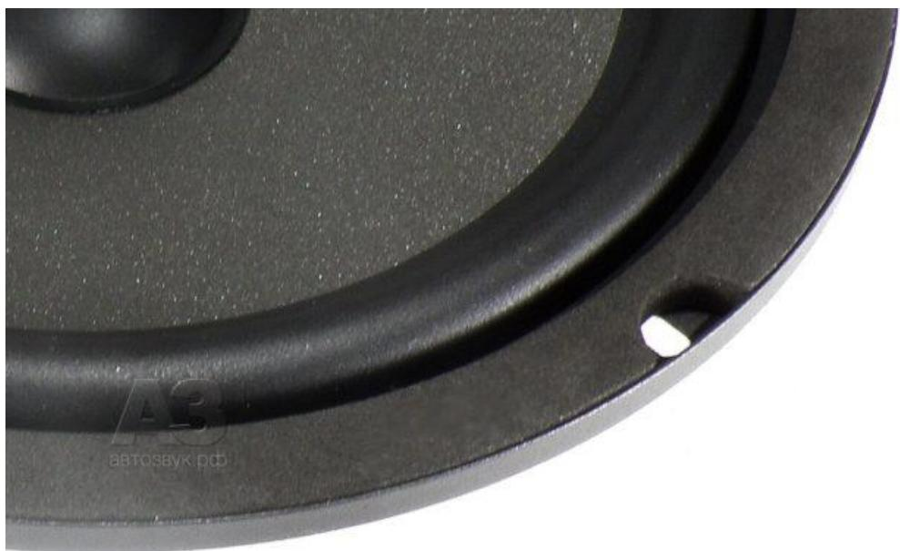
*Материал диффузора – Polyglass, целлюлоза с покрытием из стеклянных микросфер. Профиль диффузора неглубокий, но тщательно выверенный. Выпуклый пылезащитный колпачок из гладкого полипропилена, мягкий на ощупь. Диаметр звуковой катушки 25,5 мм. Резиновый подвес дополнительно усилен уплотнителем.*
