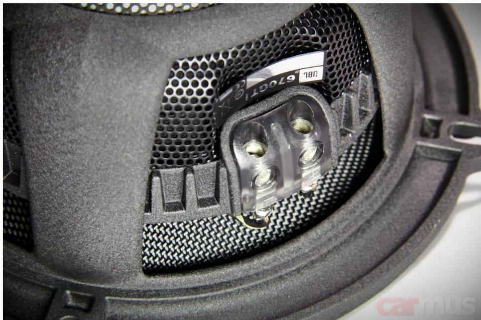
Крупное плетение – на самом деле весьма действенный способ избавиться от изгибных призвуков диффузора. При работе динамика звуковая катушка толкает диффузор, и в нём возникают механические напряжения, распространяющиеся от центра к краям. Потом они отражаются от краёв, возвращаются к центру, и всё это порождает совсем ненужные "изгибные моды". Они придают звуку неестественную окраску, а то и вовсе приводят к появлению откровенных горбов на АЧХ (любители "эстрады", вам это ничего не напоминает?).
