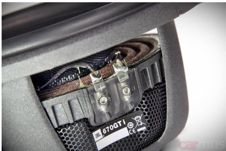
При таком размере звуковой катушки центрирующая шайба получилась тоже довольно крупной.
