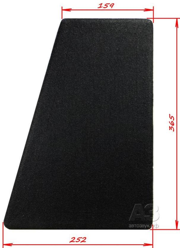
STAGE 1200B в профиль. Ширина корпуса – 436 мм, остальные размеры комментариев не требуют. Угол наклона задней стенки – 15 градусов, что примерно соответствует наклону задней спинки автомобилей (там он составляет от 17 до 22 градусов). Внутренний объем, за вычетом толщины стенок и динамика, составляет примерно 22 л, объем изделия «брутто» – 32 л
