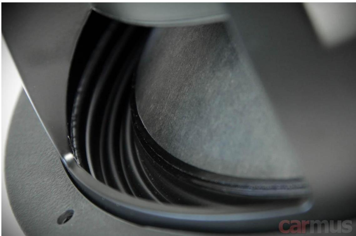
Интересно сделан фланец динамика. Фронтальная часть резинового уплотнителя снимается, открывая доступ к крепёжным отверстиям. После установки всё возвращается в исходное состояние, и головки винтов оказываются скрытыми. Эту удобную фичу Alpine даже запатентовали.
