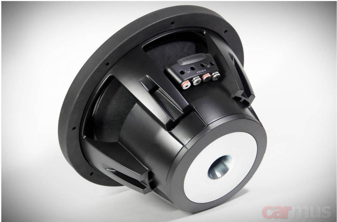
Вентиляционное осевое отверстие здесь здоровенное. Закругления краёв с наружной части позволяют избежать струйных призвуков, так что динамик, при желании, можно спокойно ставить и "горшком" наружу – "свистеть" не будет. Внутренняя часть канала тоже имеет скругления. Более того, сама форма верхней части керн тут тоже запатентована.
