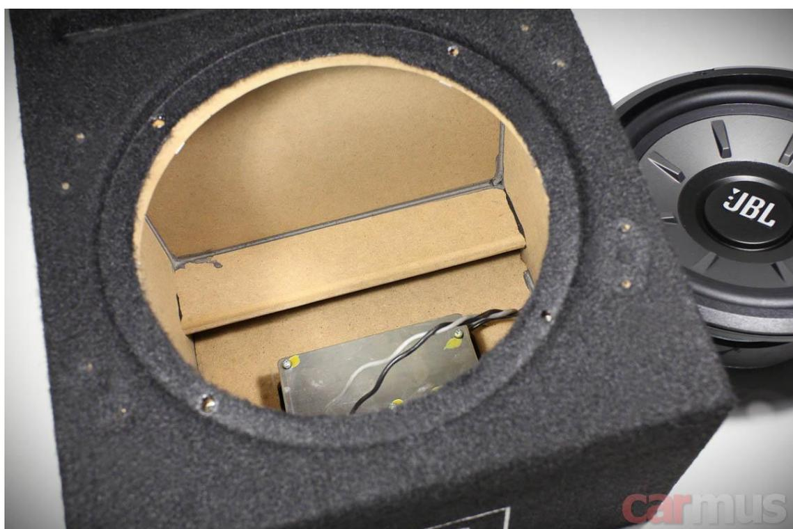
Примечательная деталь – крепление динамика. Обычно в корпусных сабах используются саморезы, здесь же – закладные гайки и нормальные винты. Немного неожиданно, тоже можно зачехлить в плюсы.
