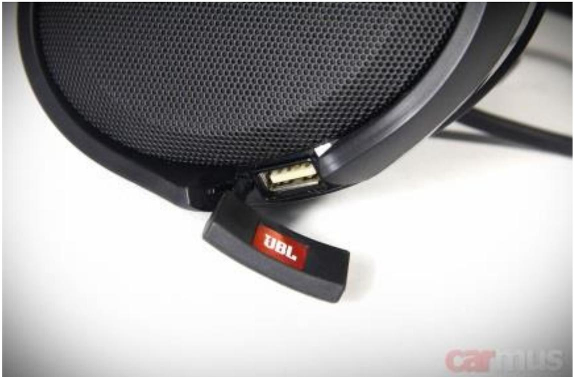
Подключение акустики до безобразия простое. Bluetooth-приёмник и усилитель сосредоточены в одном из корпусов, и от него идёт два провода. Кстати, совсем не хлипких, в плотной изоляции. Один провод – питающий, он идёт к аккумулятору. Сечение не гигантское, но вполне достаточное, среднее токопотребление всё равно не перескакивает отметку 1 Ампер (для интереса оценил токовыми клещами с возможностью измерения RMS).
