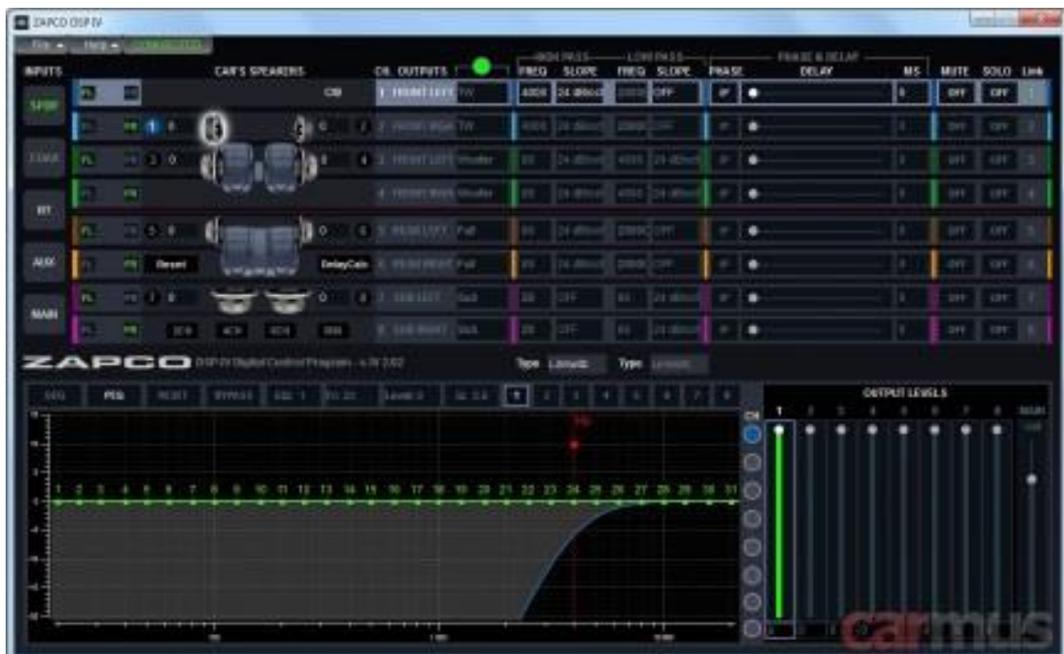
При работе от аналогового входа Main можно выбрать режим работы – брать сигнал с двух каналов, с четырёх или со всех шести. При этом можно задать, откуда будут получать сигналы выходные каналы – отдельно с каких-то конкретных входов или же микшироваться с нескольких входов.
