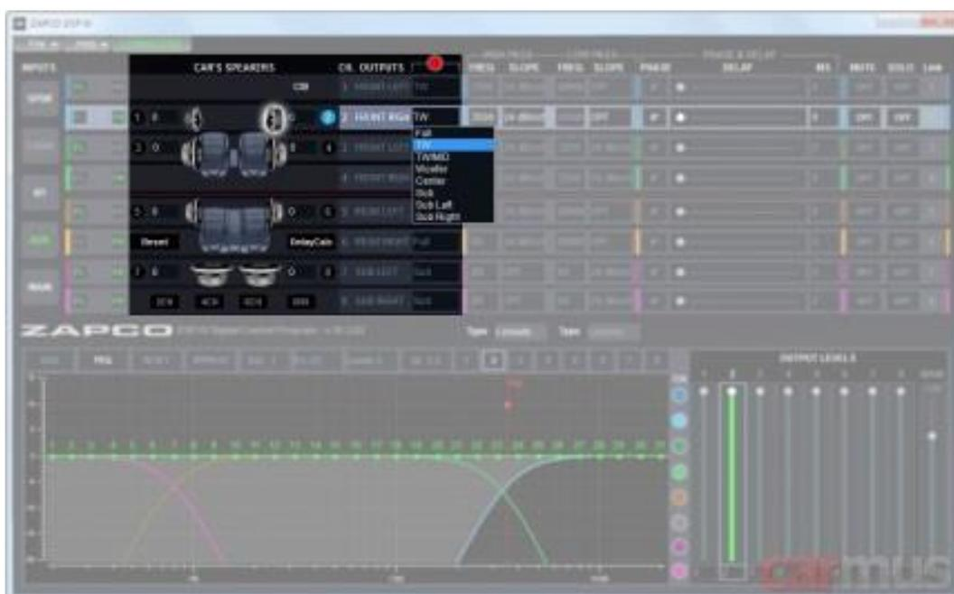
Настройки фильтров можно задать с точностью до 1 Гц, крутизну выбрать вплоть до 48 дБ/октава. Плюс к этому можно задать добротность (тип) фильтра – Баттерворт, Линквиц или Бессель. Последнее, кстати, реализовано далеко не во всех процессорах на "камне" Cirrus Logic, так что урезать его возможности тут не стали, использовали по полной программе.
