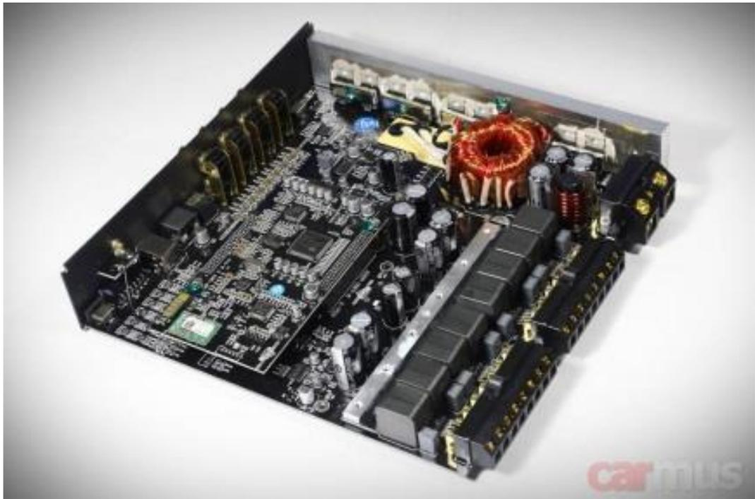
Процессор – старый знакомый Cirrus Logic 47048C-DQZ. Вот тут я бы в очередной раз предостерёг от поспешных выводов. Как оказалось, при правильной обвязке и правильной микропрограмме обработки сигнала он умеет звучать очень и очень хорошо. Но об этом чуть позже.
