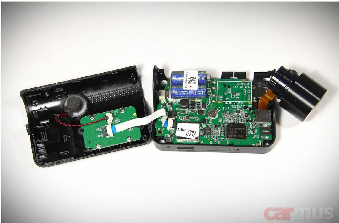
Обратите внимание, вместо привычных аккумуляторов здесь используются так называемые "суперконденсаторы", которые не боятся зимних морозов, и в случае отключения их заряда хватает для корректного завершения записи файла.
