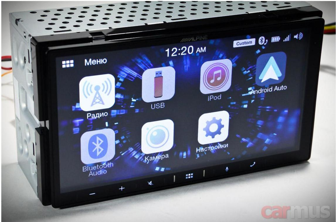
Передняя панель представляет собой цельный ёмкостный экран, включая кнопки в нижней части. Глубина корпуса всего 7 см, если считать от плоскости экрана. Задняя стенка полностью плоская, это сделано для удобства крепления к ней усилителя.
