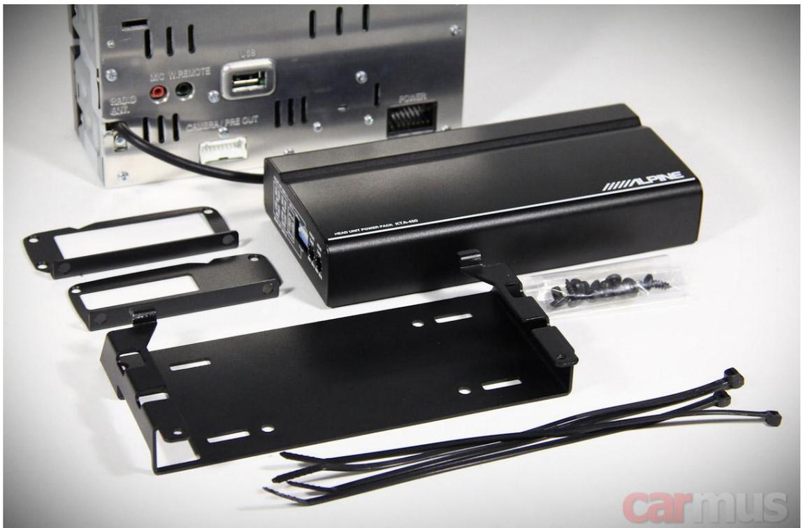
Между задней стенкой головного устройства и усилителем остаётся небольшой промежуток – в него умещаются все кабели, и к тому же так почти не страдает охлаждение задней стенки самого ГУ.
