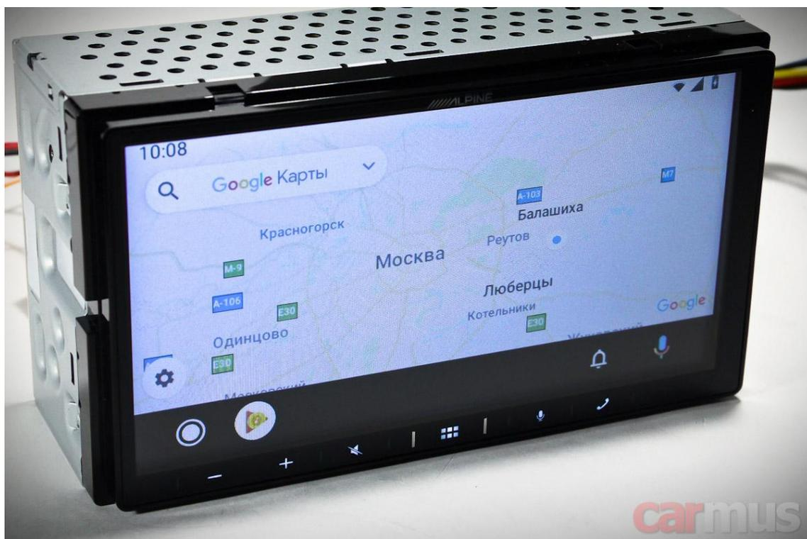
По настройкам аппарата есть один интересный момент – во время движения активны только "Подключение" и "Звук". Всё остальное можно настроить только когда машина стоит (точнее, когда провод Parking Brake замкнут на "массу", но не мне вам говорить, как его обычно подключают).
