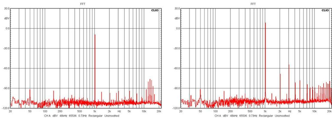
Правда, при малых уровнях сигнала на выходе появляются какие-то артефакты в области ВЧ, но это больше похоже не на результат компоновки и трассировки платы, а на специфику схемных решений D-класса. Уровень их, правда, невысок, и с ростом полезного сигнала они исчезают. Но при анализе КГИ на разных мощностях дадут о себе знать небольшим горбиком в самом начале графика. Зная его причину, можно сказать, что ничего критичного в этом нет.
