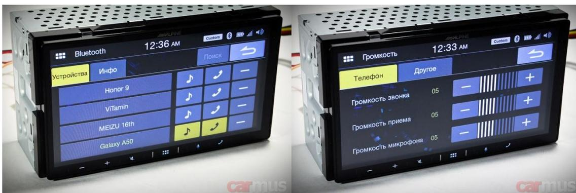
Заявлена версия Bluetooth 4.2, но в режиме аудиостриминга поддерживается только кодек SBC, переключения на AAC и aptX не происходит. Названия треков и прочая информация отображается на экране как обычно, треки тоже можно переключать с головного устройства.
