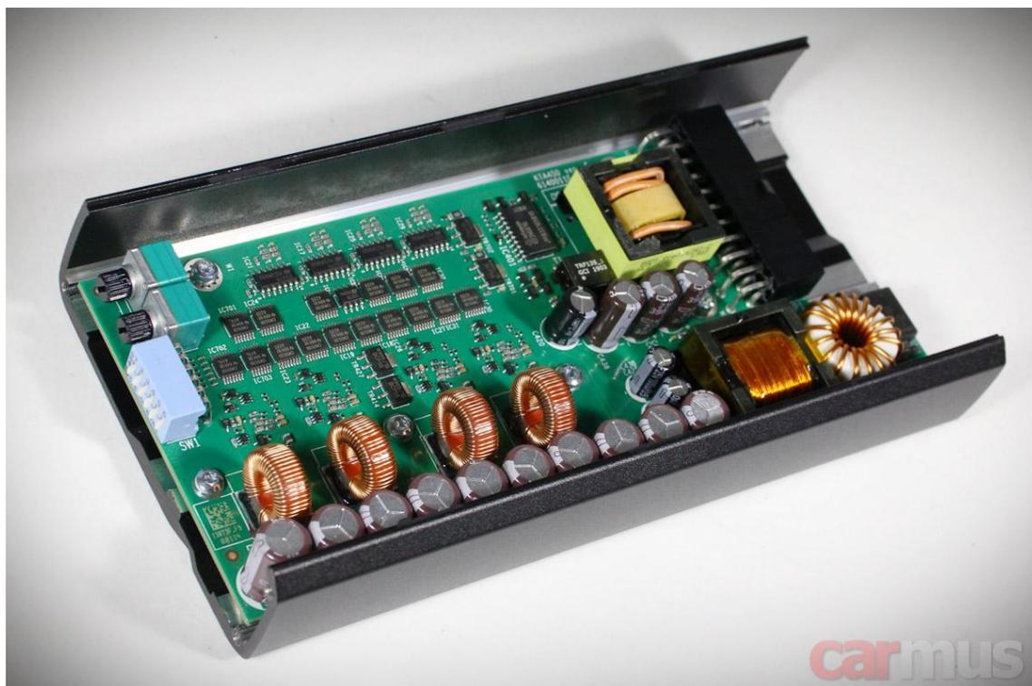
Блок питания небольшой, но учитывая высокий КПД, заявленные 4x50 Вт RMS должен вытянуть. Проверю чуть позже.
